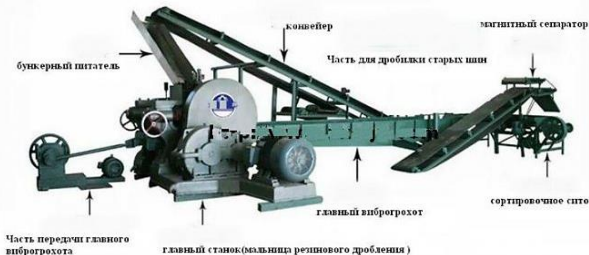
Рис. 2 - Второй сектор: переработка чипсов в крошку на вальцах
